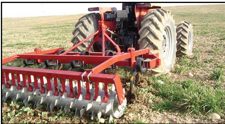
شکل ۳- خاک‌ورزهای مرکب با شاخه‌های نیمه عمیق برای کم‌خاک‌ورزی.
