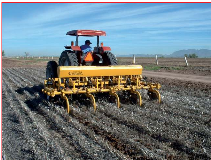
شکل ۷- شکل دادن مجدد به شیارها یا فاروئهای آبیاری در سامانه بسترهای بلند بدون تخریب بسترها
