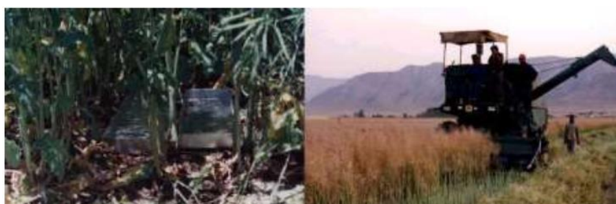
شکل ۹۹- اندازه‌گیری تلفات شانه برش (تلفات جمع‌آوری)
