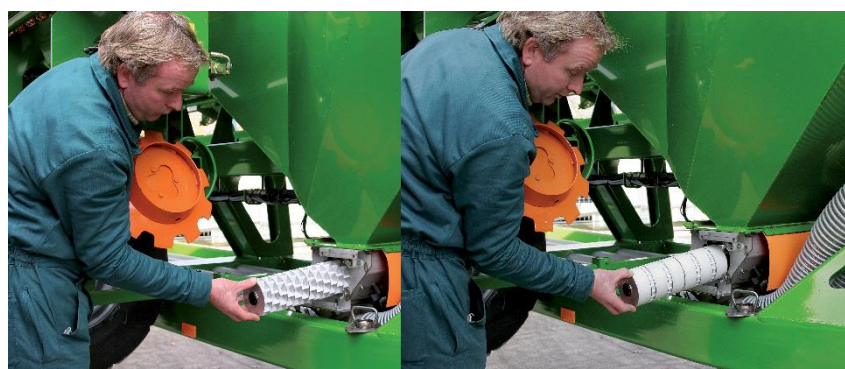
شکل ۴۴- تعویض غلتک (کارت‌ریج) با توجه به اندازه بذر
