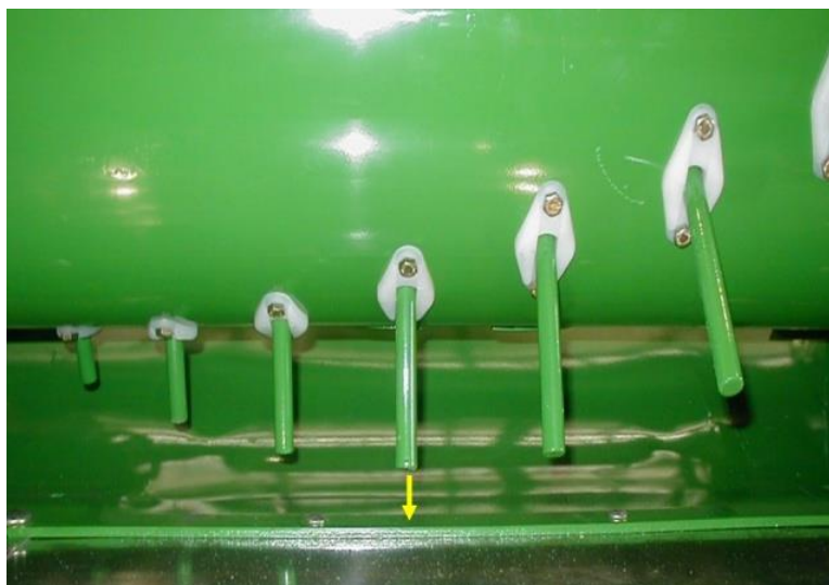
شکل ۹۳- فاصله انگشتی‌ها تا کف سکو
