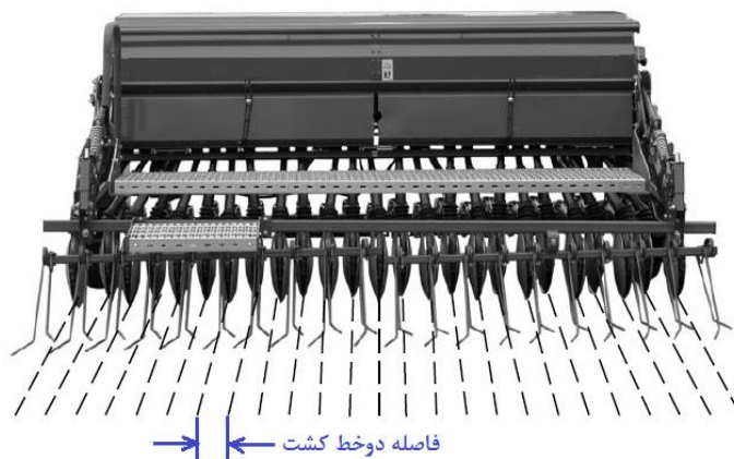
شکل ۳۰-۳۰- فاصله بین خطوط در کشت با خطی کار
