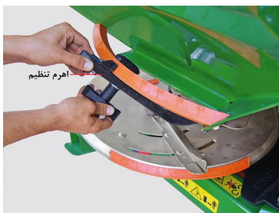
شکل ۲۷- تنظیم دریچه خروجی کود از مخزن
