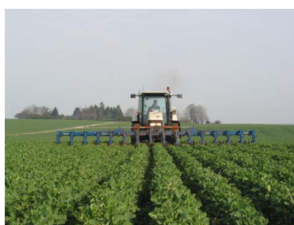
شکل ۵۹- نیاز به افزایش فاصله ردیف برای مبارزه مکانیکی علف‌های هرز موجب تبدیل الگوی کشت مربعی به مستطیلی می‌شود.
