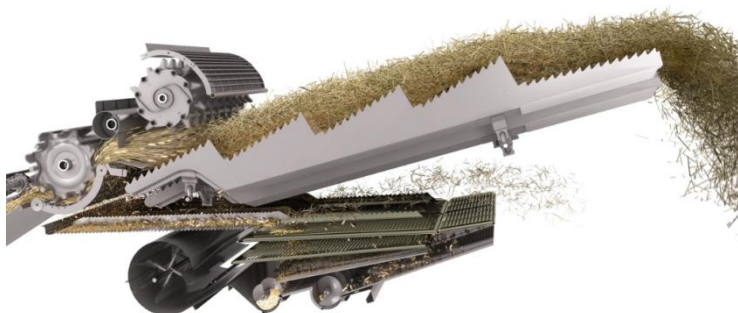
شکل ۷۹- جریان انتقال مواد از کاه‌برها به سینی دانه
