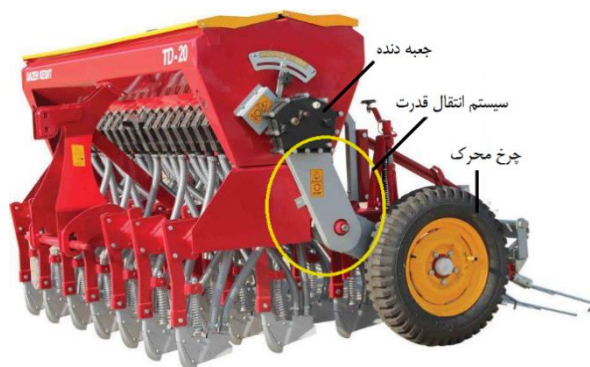
شکل ۳۳- نمای کلی انتقال قدرت از چرخ محرک به محور موزع
