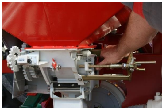
شکل ۴۳- نحوه تنظیم مقدار ریزش بذر
