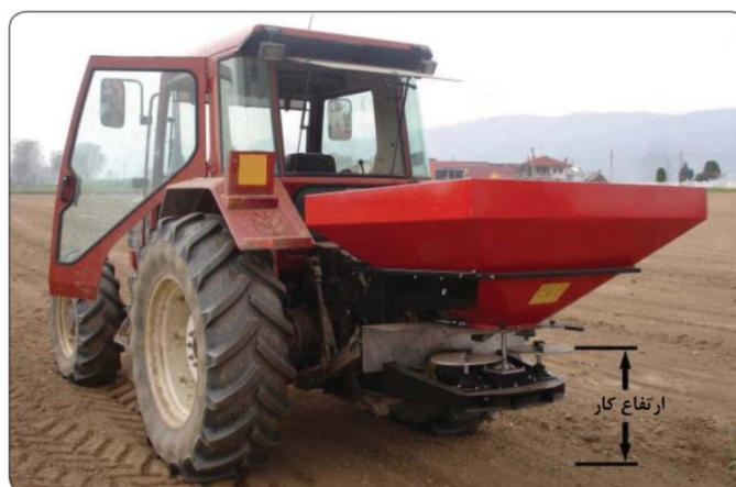
شکل ۲۶- تنظیم ارتفاع کار (فاصله از دیسک تا زمین)
