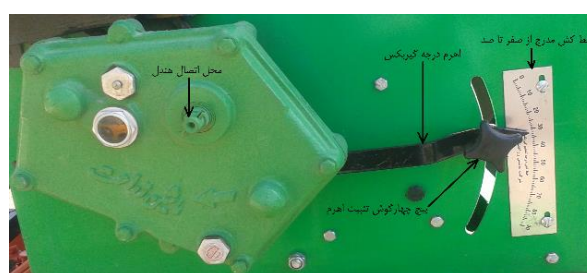
شکل ۴۸- محل قرارگیری هندل و تنظیم اهرم درجه گیربکس
