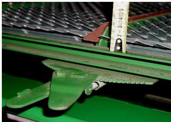
شکل ۸۵- تنظیم سوراخ‌های الک بالایی
