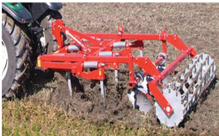
شکل ۱- استفاده از خاک‌ورز مرکب برای آماده‌سازی بستر بذر
